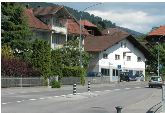
Abbildung 1 Mittelinsel als Querungshilfe
