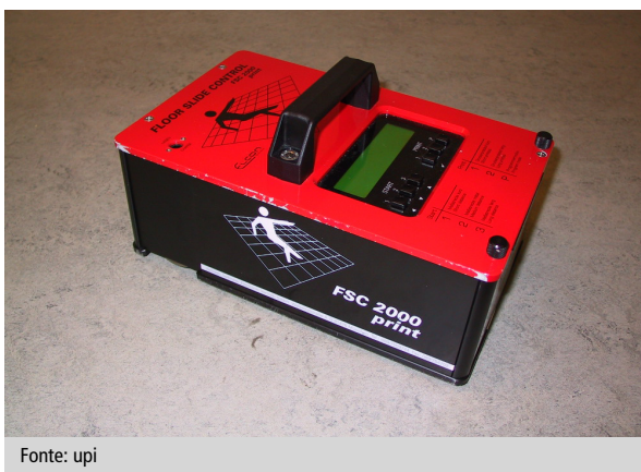
Immagine 3 Rilevamento in loco con apparecchio di misurazione mobile
