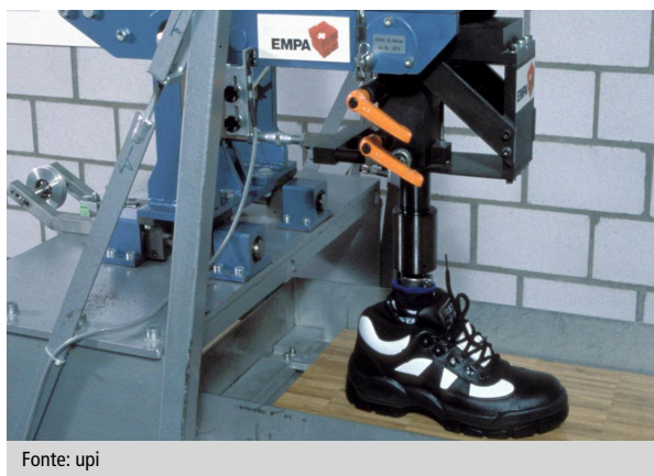
Immagine 1 Apparecchio per test di pavimenti e scarpe BST 2000, EMPA San Gallo
