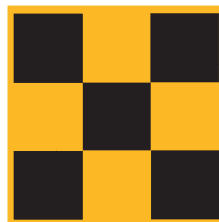
9 Bandierine per indicare sbarramenti e barriere
