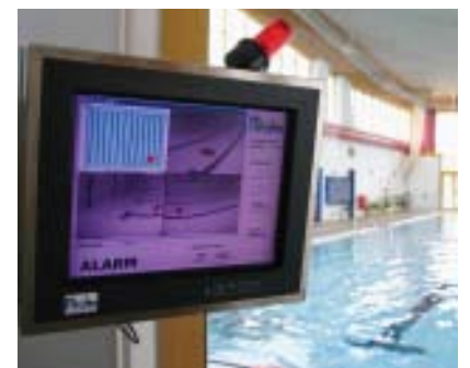
L'allarme scatta sul monitor quando la telecamera sommersa individua una persona che giace inerte sul fondo vasca.
